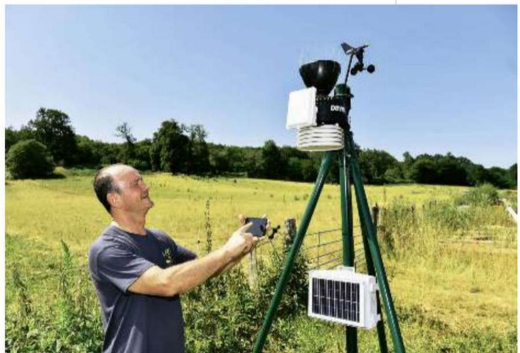
▲ La ferme expérimentale du Mourier, en Haute-Vienne, possède une station météo connectée aux smartphones, qui donnent en temps réel pluviométrie, hygrométrie, pression atmosphérique, etc.
